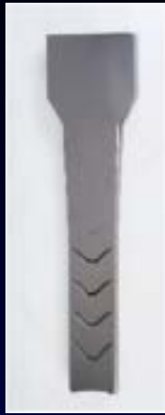
多段押し出しにおける シェブロンクラック
